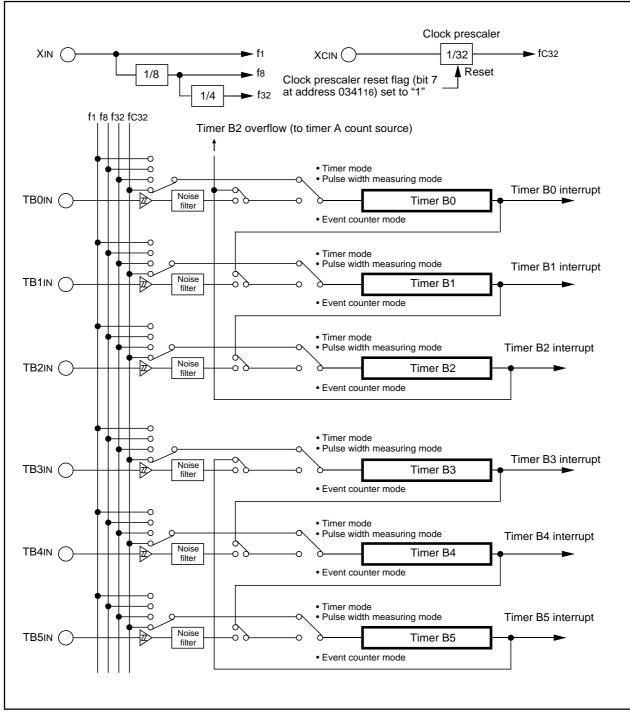
Figure 1.12.2. Timer B block diagram
